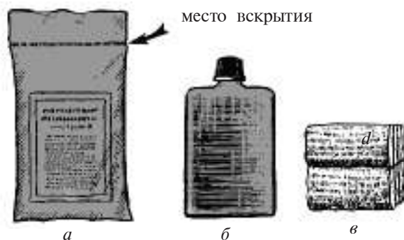
Рис. 79. Индивидуальный пакет ИПП-8: а — общий вид; б — стеклянный флакон с жидкостью; в — ватно-марлевый тампон
