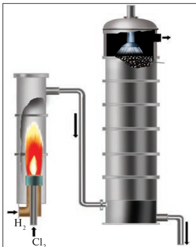
Рис. 17. Получение хлорида водорода в промышленности
